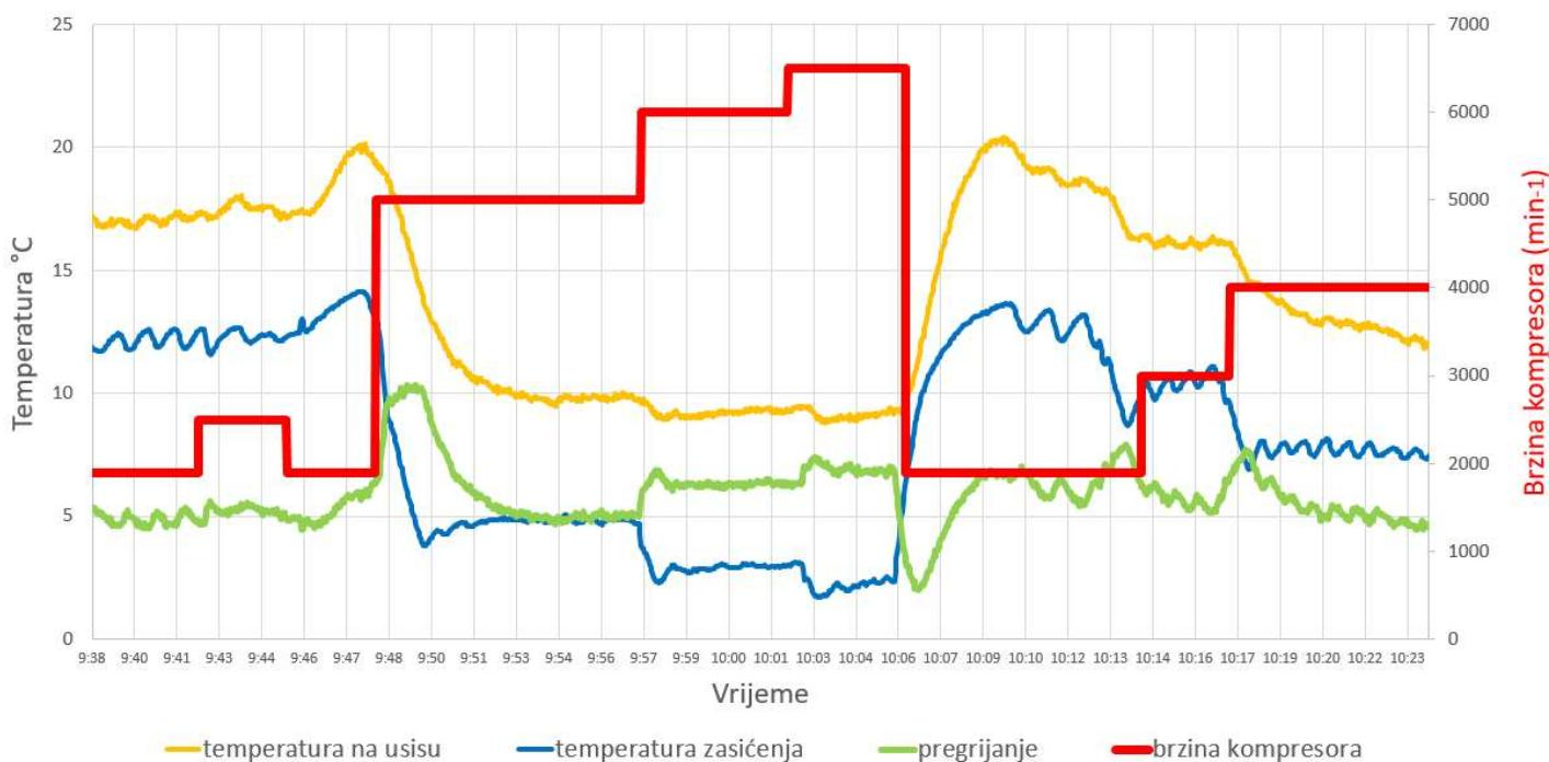
Zabilježeni podaci (u vremenskom intervalu od 2 sekunde) pokazuju kontrolnu funkciju TX7 ventila u sustavu s pločastim izmjenjivačem i Copeland Scroll kompresorom s promjenjivom brzinom rada između 1900 i 6500 min⁻¹.
